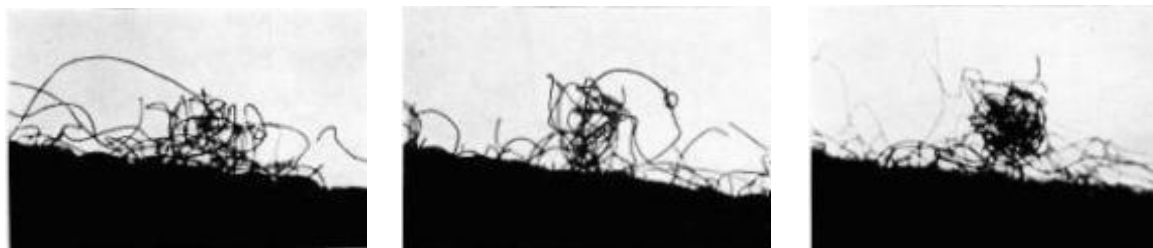
Fotografía 4. Comienza el apelsonamiento de fibras Fotografía 5. Se rompen algunas fibras que pasan al interior de la bolita, que va adquiriendo forma esférica Fotografía 6. Se ha formado una bolita que es sujeta al tejido mediante fibras más largas que le sirven a modo de anclaje
